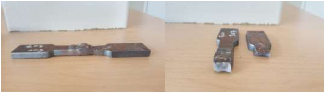
Resim 2. Kaynaklı birleştirme yapılmış ve çekme testi uygulanmış bir numune görüntüsü
