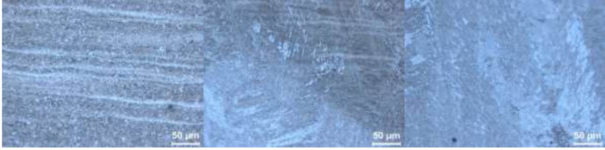
Şekil 1. Protac 500 X 90-IG kaynaklı birleştirilmesi
